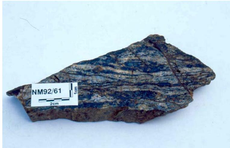
Abb. 3-26: Handstück eines Bio-Ser-Chltd-Gr-Schiefers mit deutlichem Lagenbau und bläulichen Ser-Pseudomorphosen.
