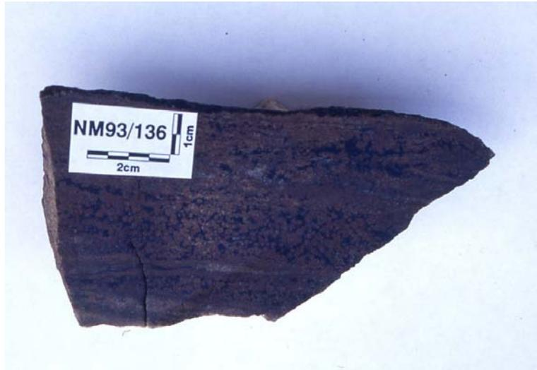
**Abb. 3-29:** Handstück vom Gr-Bio-Fels mit idiomorphem Gr der Bio überwächst (bei Interesse liegt das Originalfoto beim Autor auf).
