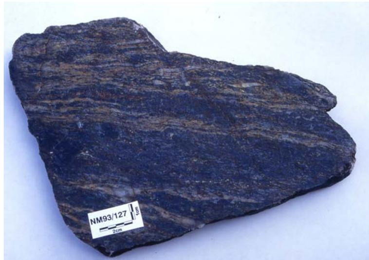
**Abb. 3-28:** Handstück eines Chl-Ser-Gr-Schiefers mit den typischen Qu-Zeilen und der charakteristischen bläulichen Farbe in den Ser-Bereichen (Pseudomorphosen-Charakter ist durch die Deformation nicht mehr zu erkennen).
