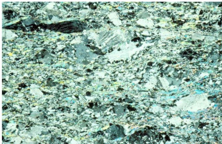
**Abb. 3-17 a&b:** Mittelkörniger O-Gneis aus dem Freiburger Steinbruch mit 2 Hgl-Generationen (die jüngere Generation ist an ihrer grünlichen Farbe leicht erkennbar) und der feinkörnigen Augentextur um die AlkF; NM92/1; BB 15 mm; =N und +N.
