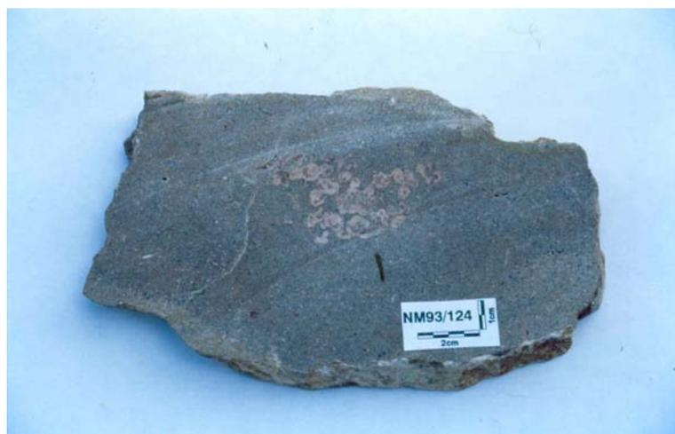
**Abb. 3-3:** Handstück eines Rhodolithen-führenden Kalksandsteins mit kleinen, länglichen, inkohlten Pflanzenhäckseln.
