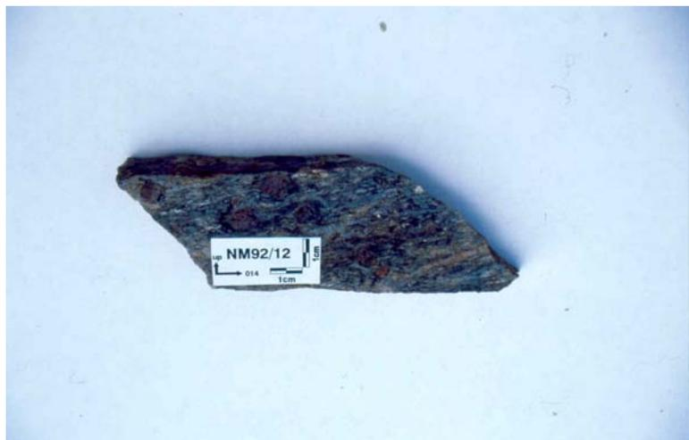
Abb. 3-8: Handstück eines Mu-Chl-Bio-Gr-Schiefers mit türkisen Chltd-Pseudomorphosen (x-z-Schnitt).
