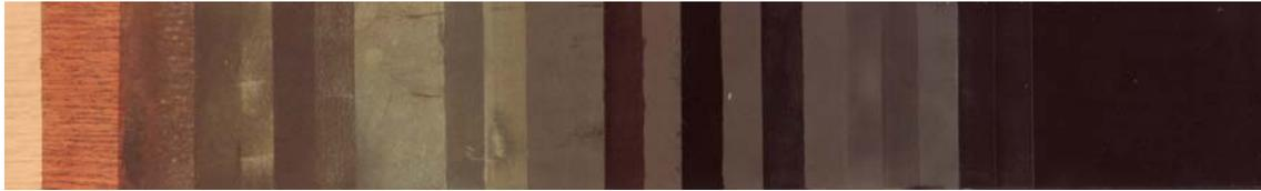
Abb. 24: Musterbrett mit den einzelnen Arbeitsschritten zum Aufbau einer planen schwarzen Lackoberfläche
