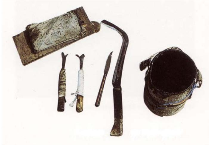
Abb. 16: Werkzeuge zur Lackgewinnung
