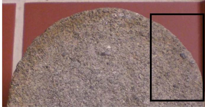
Abb.4.40: Randlich durch Spülung beeinflusster Bohrkern. Das schwarze Viereck entspricht dem angefertigten Dünnschliff und der Position der Probe in Abb.4.41 und 4.42.
