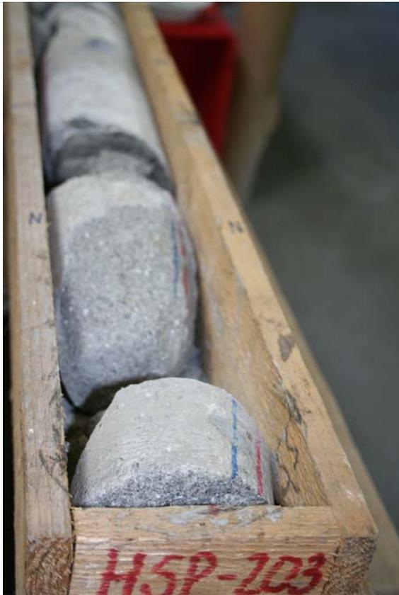
Abb.3.1: Sandsteine des Haidach – Speichers, Homogener Abschnitt eines Bohrkernes.
