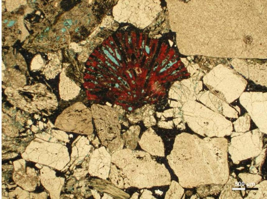
Abb.5.3: Korallenbruchstück in Fe- dolomitzementiertem Sandstein. Komponenten zeigen teils fehlende sowie Punkt- bis Flächenkontakte. Dünnschliffbild aus Probe 1/18, 1702,5 m, gasgesättigte Zone.
