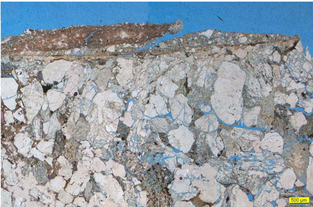
Abb.4.38: Dünnschliffbild von einem Bohrkern mit Spülungskruste am Rand. Probe 1/2, Tiefe 1715,2 m, Übergangszone.
