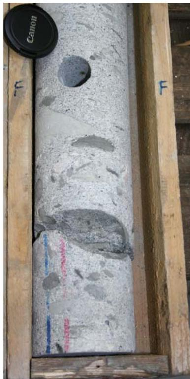
Abb.4.34: Bohrkern mit großen Ton- und Karbonatklasten.
