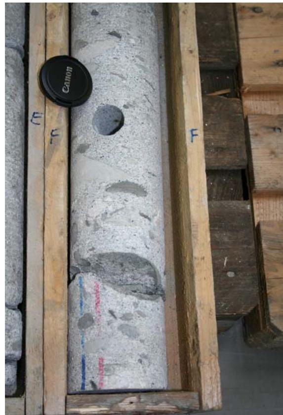
Abb.3.2: Sandsteine des Haidach – Speichers, brekziöser Abschnitt eines Bohrkerns mit Ton- und Karbonatklasten.
