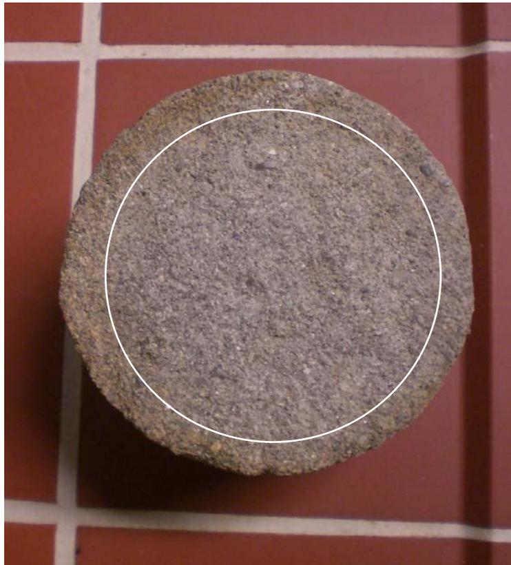
Abb.4.37: Verfärbung des Bohrkernes durch die Bohrspülung. Probe Nr. 1/18, Teufe 1702,5 m, gasgesättigte Zone.
