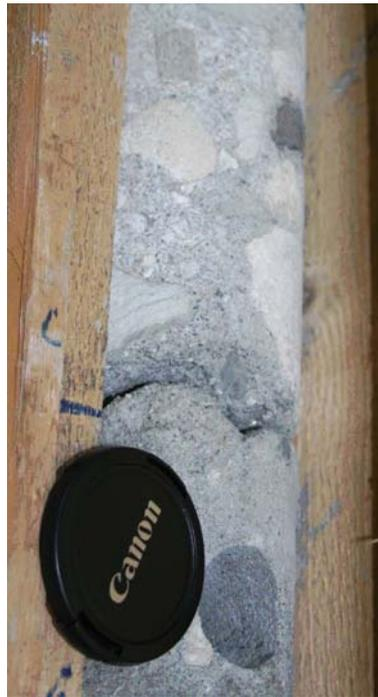
Abb.4.4: Bohrkern mit hellen Kalkbruchstücken und dunkleren Tonklasten.
