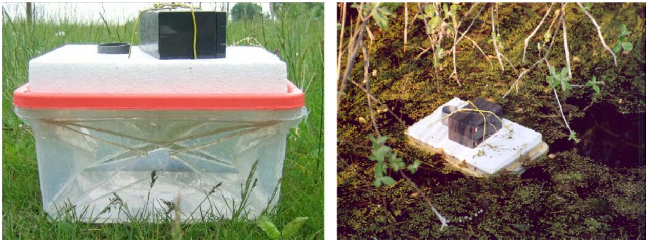
**Abb. 12:** Seitenansicht (links) und schwimmend eingesetzte Lichtfalle (rechts).
