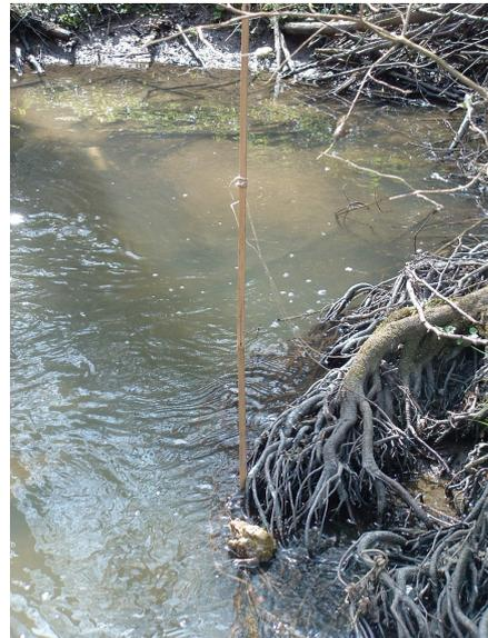
**Abb. 40:** Pegel in Abschnitt B2. Thermometer unter der Wasseroberfläche exponiert.
