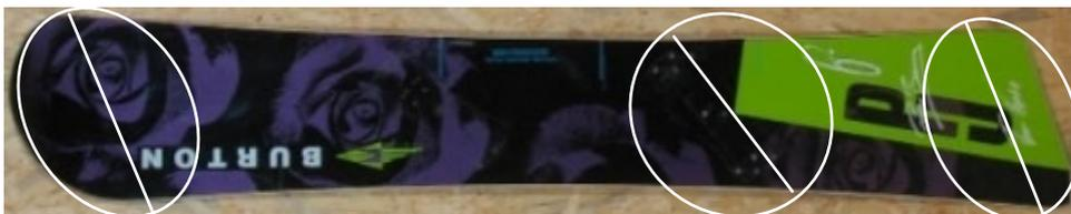
**Abb. 12.: Asymmetrisches Snowboard. Die zwei Kanten sind gegenüber der Brettlängsachse parallel verschoben. Dadurch sind die Druckpunkte auf beiden Kanten annähernd an der gleichen Position. Im Mittelkreis die Bindungsinserts.<sup>15</sup>**
