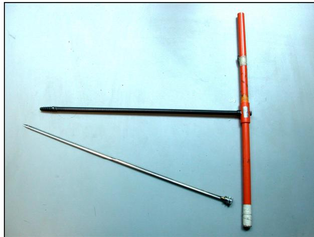
Abb. 3.1: Zuwachsbohrer und Extraktor (Foto: eigenes Foto)
