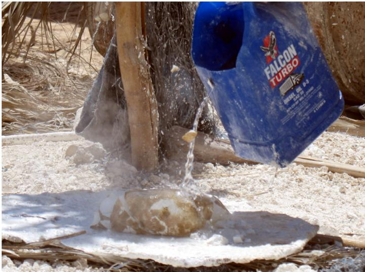
Bild 52: Löschen des Kalks
