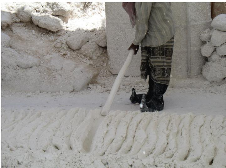
Bild 53: Bearbeitung des gebrannten Kalks
