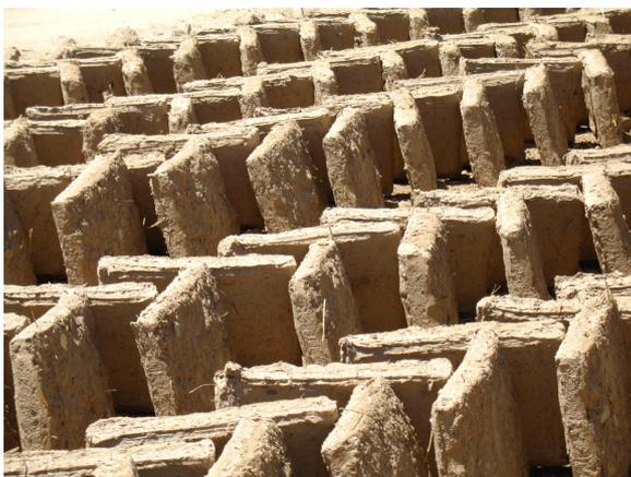
Bild 48: Lehmziegel liegen zum Trocknen in der Sonne
