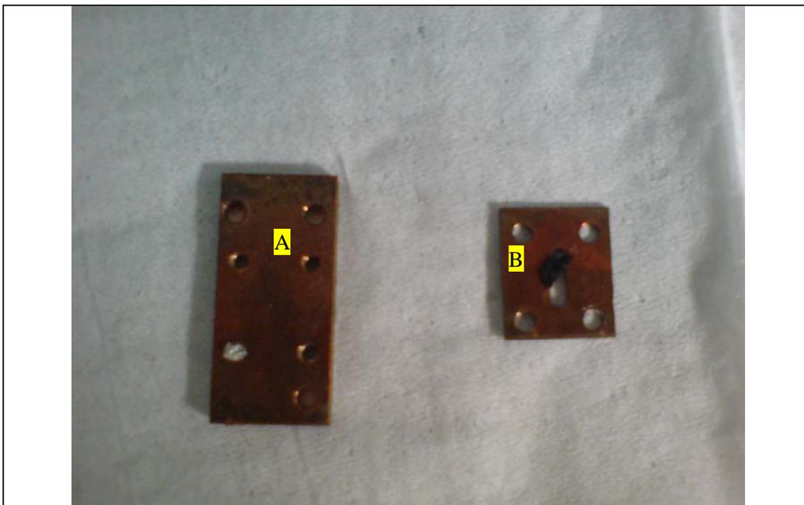
Abb. 3.3 Probenhalterung aus Kupfer, die bei den Experimenten verwendet wurden. Die Probe wird zwischen den beiden Plättchen eingeklemmt und verschraubt. (A) Probenhalterungsgrundplatte, (B) Blende mit Probe auf dem Messspalt
