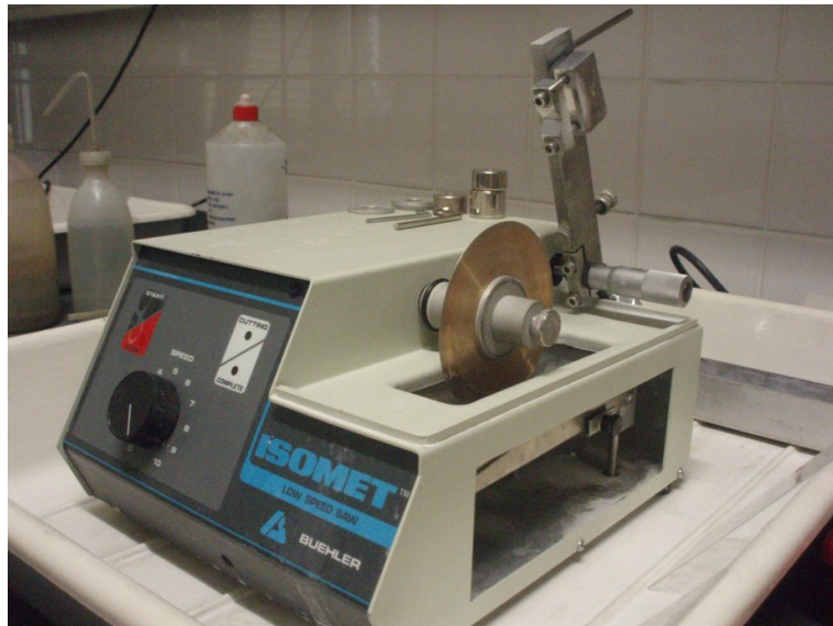
Abbildung 15: wassergekühlte Niedertour- Minikreissäge Isomet™
