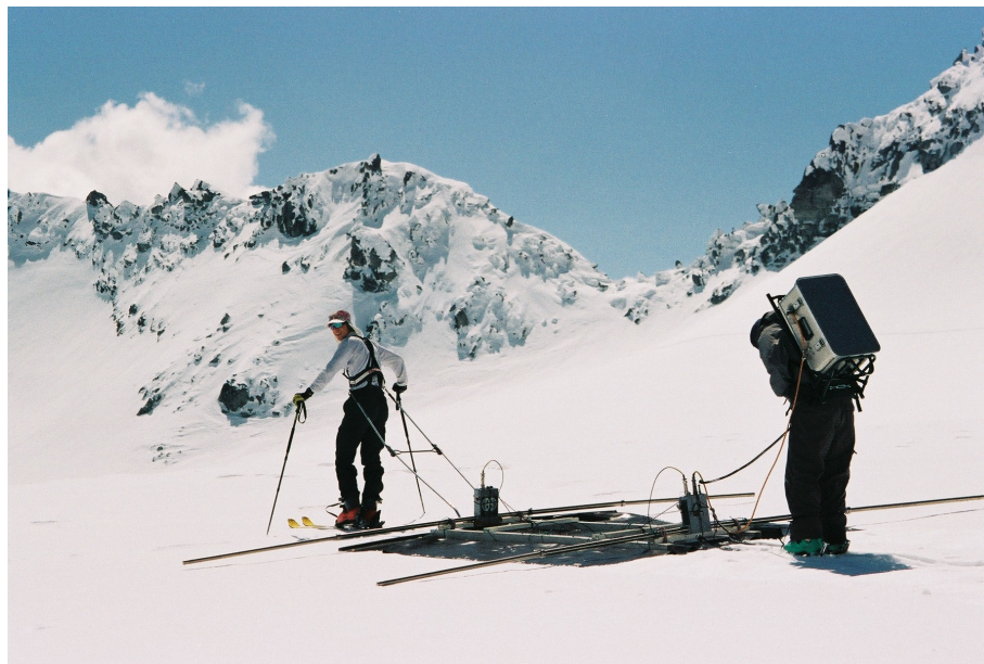
Abbildung 9.4: Die MLF Antenne mit 20 MHz Einstellung fixiert auf dem Fiberglasrahmen. Zur besseren Manövrierbarkeit wurde noch eine Plane untergelegt und befestigt. Foto: B.Hynek, 2004
