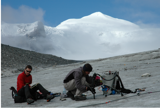
Abbildung 4.3: Mittels eines Dampfbohrers werden Ablationspegel (z.B. Plastikrohre) im Eis versenkt. Durch regelmäßiges ablesen kann man dadurch punktuell die Ablation bestimmen. Foto: G.Weyss, 2005
