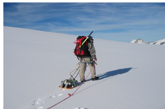
Abbildung 4.6: GPR-Schneemächtigkeitsmessung mit einer Messfrequenz von 500 MHz. Foto: G.Koboltschnig, 2005
