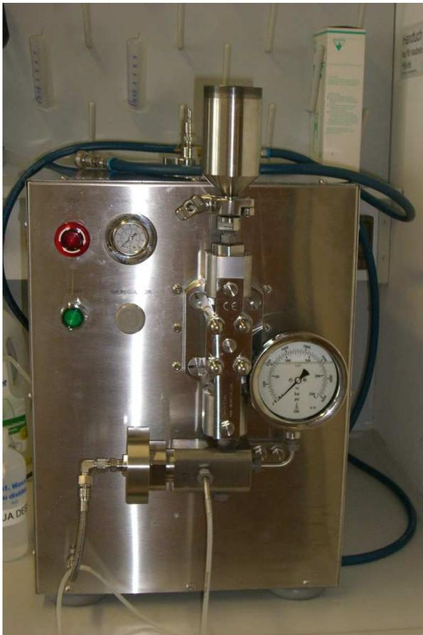
Abbildung 11: Hochdruckhomogenisator EmulsiFlex – C3<sup>4</sup>
