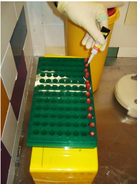
Abb. 6: Verkleben des Bohrlochs mit Sekundenkleber.
