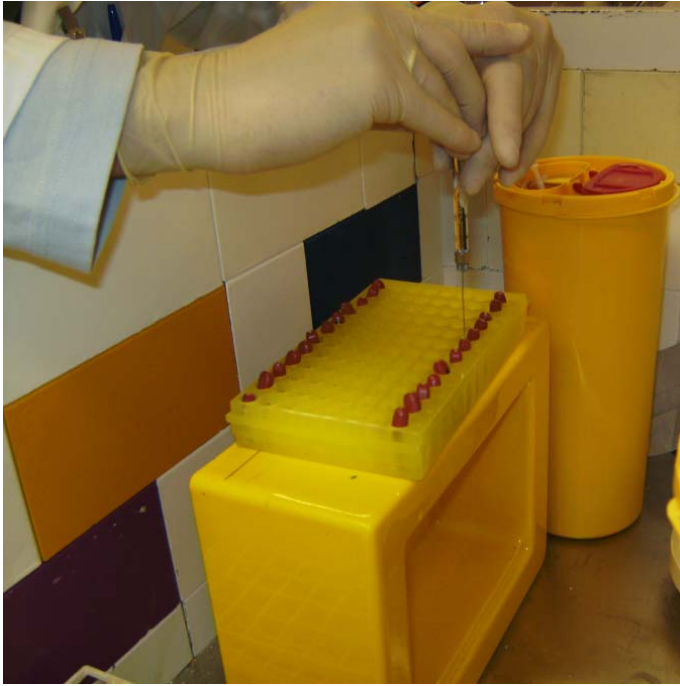
Abb. 5: Befüllung der Tabletten mit einer Hamilton-Spritze.
