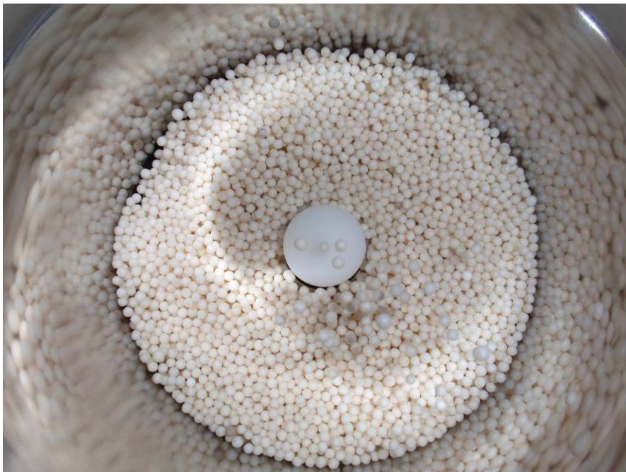
Abb. 32: Pellets im Wirbelschichter bei 40 % Ventilation.
