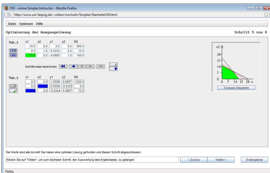
Abbildung 5.6.3.6: Bestimmung der optimalen Lösung – Iteration 2
