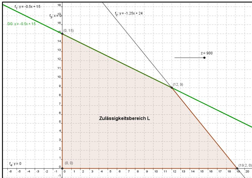
Abbildung 5.2.10: Graphische Bestimmung der optimalen Lösung (Sonderfall 1) – Koordinatengitter
