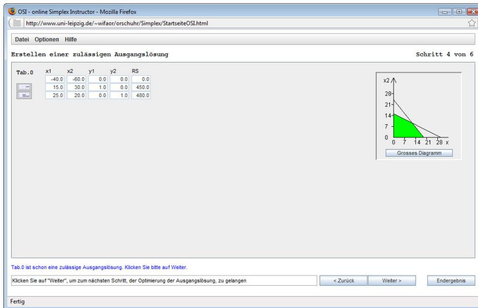
**Abbildung 5.6.3.4:** Erstellen einer zulässigen Ausgangslösung
