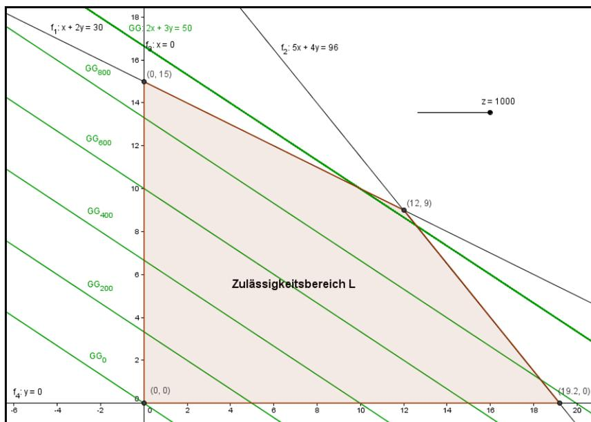
Abbildung 5.2.4: Graphische Bestimmung der optimalen Lösung (1)
