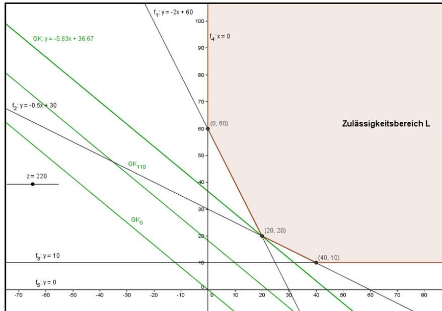
**Abbildung 5.2.7:** Graphische Bestimmung der optimalen Lösung (3)
