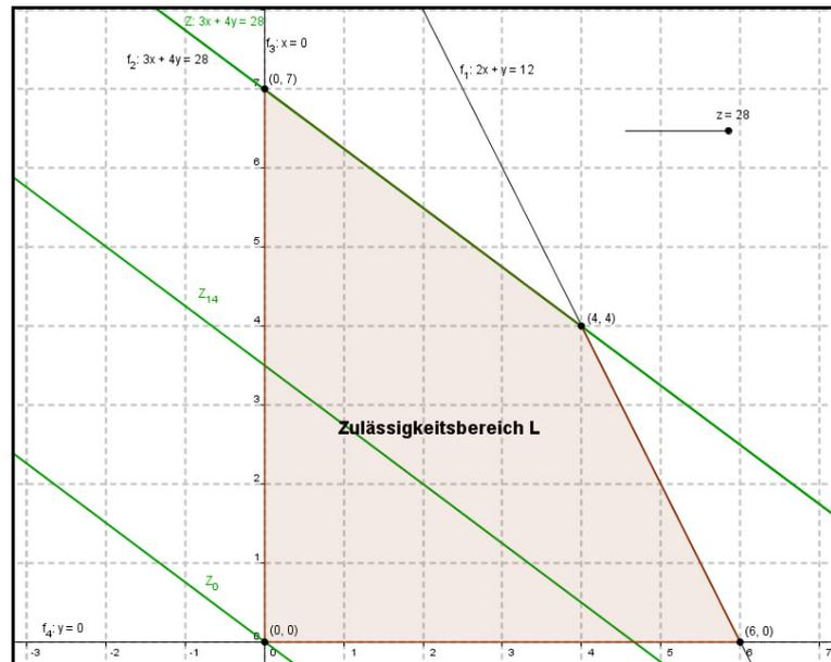
Abbildung 5.2.11: Graphische Bestimmung der optimalen Lösung – Sonderfall 1 (2)
