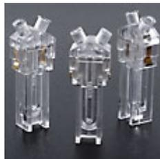
Abb. 3.2.3. Messzellen zur Ermittlung des Zetapotentials (29)
