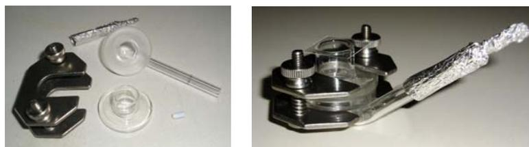
Abb. 3.3.2. Franz-Diffusionszelle in Einzelteilen und zusammengesetzt
