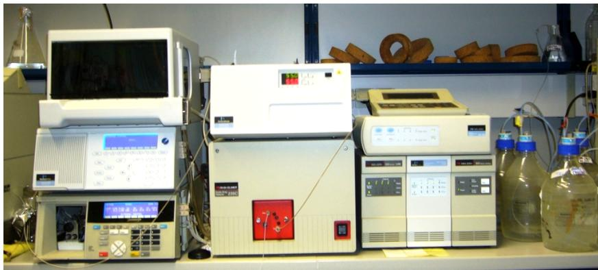
Abb. 26 HPLC-Anlage.
