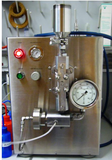
Abb. 19 Hochdruckhomogenisator EmulsiFlex-C3.
