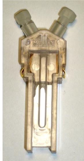
Abb. 23 Zetapotentialküvette.
