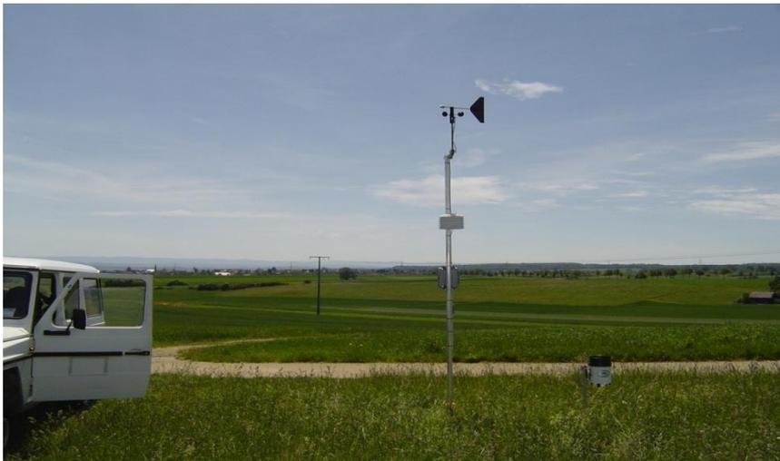
Abb. 3.1 HOBO Wetterstation mit Anemometer in 3 m Höhe
