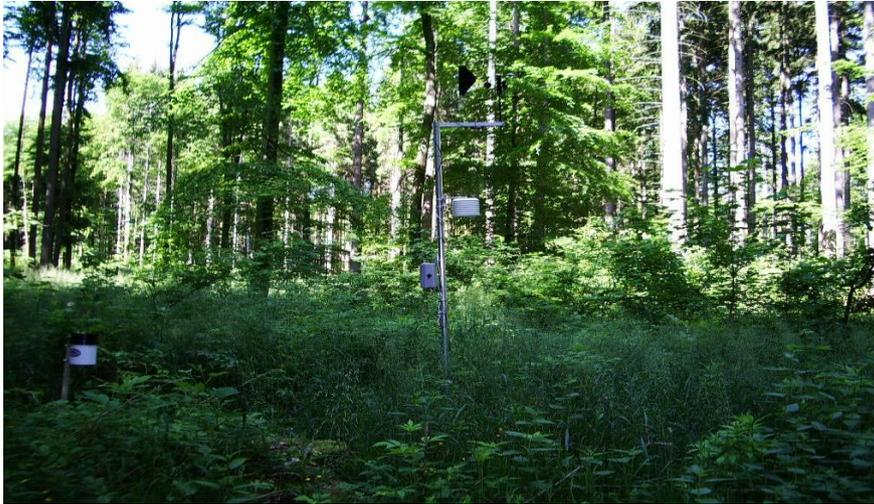
Abb. 3.2 HOBO Messstation mit hoher Rauigkeitslänge
