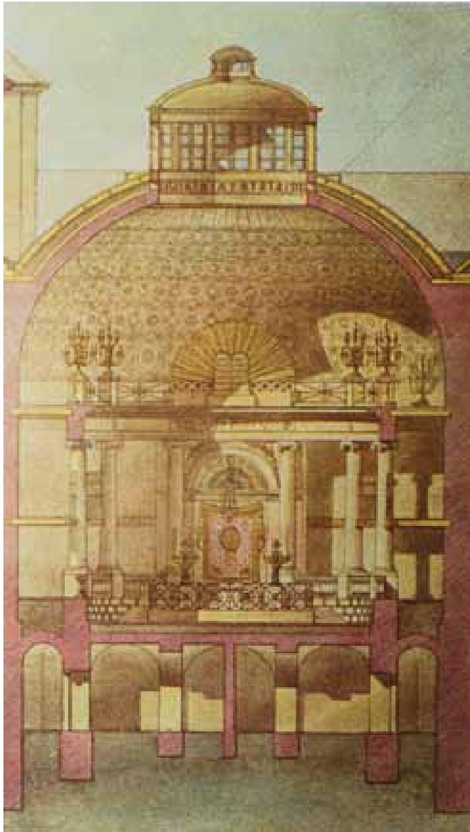
Abb. 233: Querschnitt des Stadttempels nach einer Originalzeichnung von Josef Kornhäusel.
