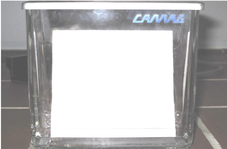
Abbildung 5: Entwicklung eines Dünnschichtchromatogramms
