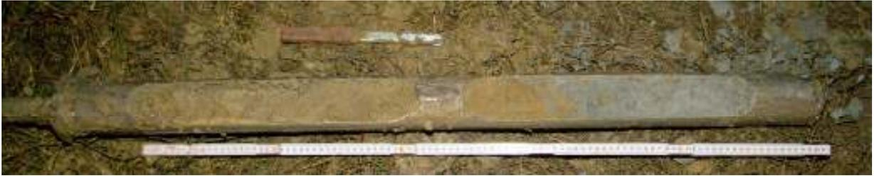
**Abb. 64: 3. Sandschicht (SW 7/1) und 4. Laminierte Schicht (SW 7/2)**
