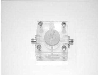
**Abb. 16:** Plexiglasmesszelle mit Dualelektroden
