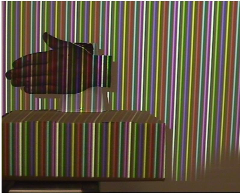
Abbildung 3.31: Streifenbild des Fast-Scans mit Farbstreifen: Aufnahme einer Testanordnung
