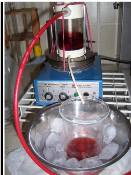
Abbildung 20: Aufbau der UFE (Amicon Division, USA)
