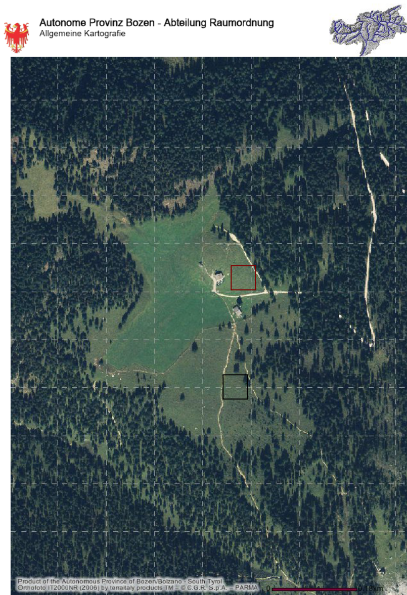
Abbildung 23: Oberflächenbuckelung auf der Glatz Alm (rotes Rechteck: Testfläche für Tachymetermessung; schwarzes Rechteck: Skizzierung der Buckelwiesenoberfläche samt Baumwuchs)
