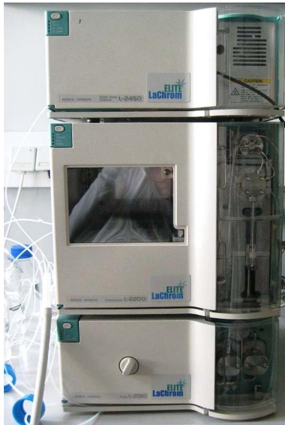
Abbildung 19: HPLC-Gerät
