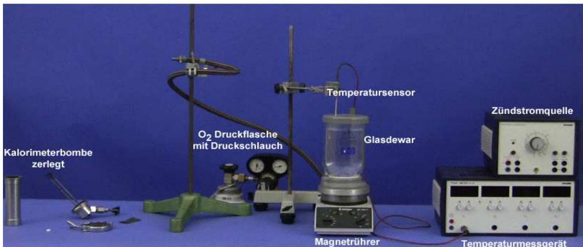
Abbildung 27: Experimentieraufbau samt Beschreibung der einzelnen Geräte
