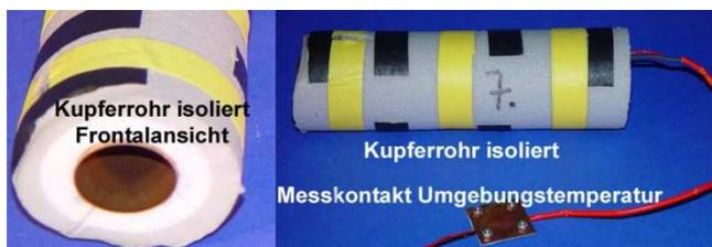
Abbildung 12: Kupferrohr zur Messung des Grundumsatzes einer Maus
