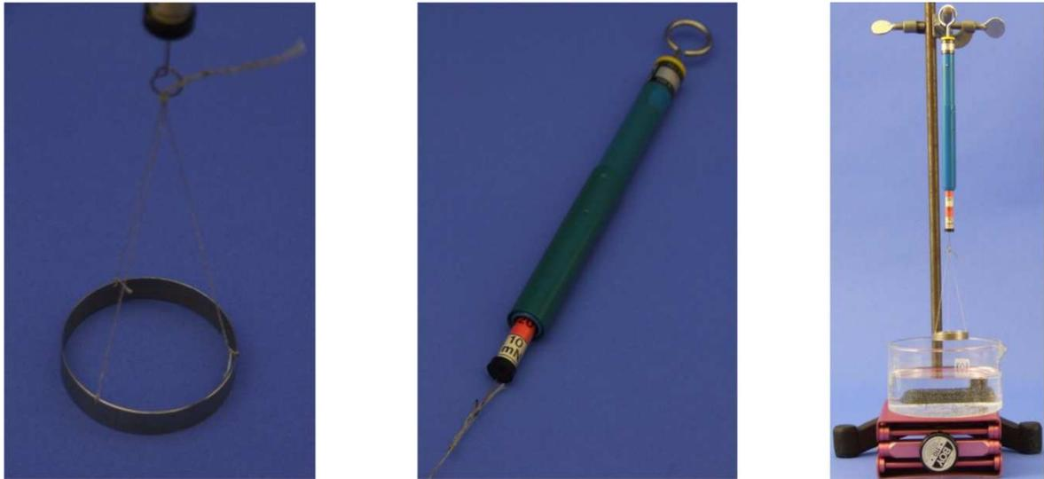
Abbildung 37: Aluminiumring; Federwaage; Aufbau Experiment-Oberflächenspannung
