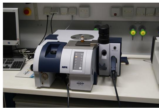
**Abb. 4:** *MPA Multi Purpose FT-NIR Analyzer. Privataufnahme.*
