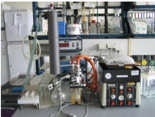
Abb. 15: Fractovap, Vakuumschüttler, Vakuumpumpe
