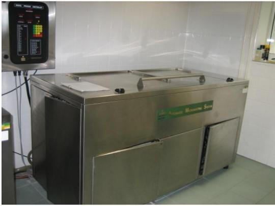
Abb. 11: Kleinmälzungsanlage
