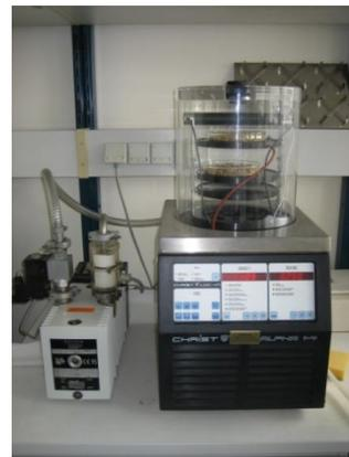
Abb. 14: Gefriertrockner mit Vakuumpumpe
