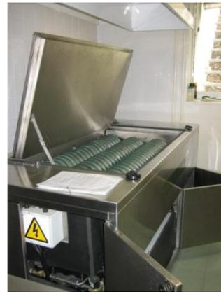
Abb. 12: Kleinmälzungsanlage bestückt mit Edelstahl-Behälter
