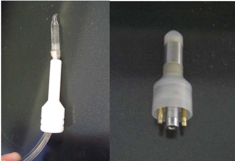
**Abbildung 4-3:** linke Bildhälfte: Lugginkapillare; rechte Bildhälfte: Zylinderelektrode. Die Spitze vor dem Stahlzylinder ist abnehmbar und der gehöhlte Stahlzylinder kann ausgetauscht werden.
