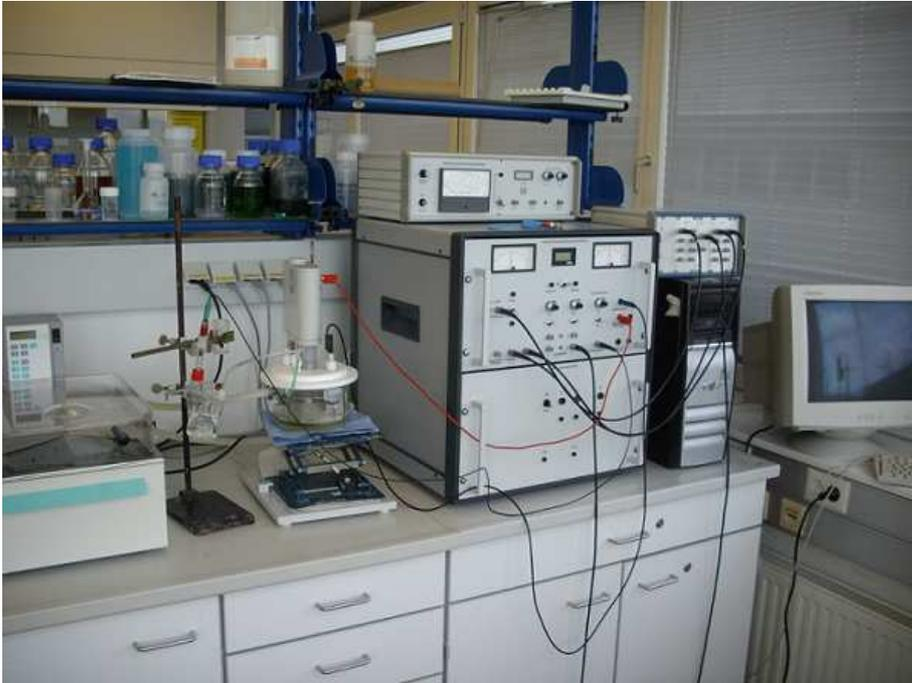
**Abbildung 4-1: Versuchsanordnung der Zylinderelektroden-Experimente. Die Zelle steht auf der Laborhebebühne und fasst ungefähr  $750\text{ ml}$ .**
