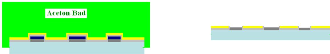
(14) Chromschicht-Ätzung: Entfernung des freiliegenden Chroms; dann Spülung mit deionisiertem Wasser und Trocknung mit Stickstoff.
