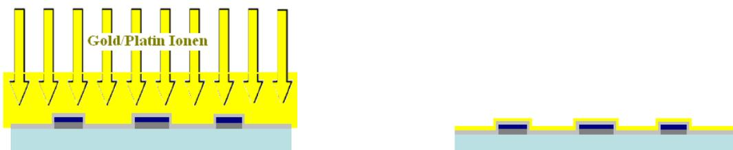
(13) Lift-Off des Resists im Acetonbad (Ultraschall darf bei der gegebenen Schichtdicke nicht verwendet werden); danach Reinigung im Isopropanolbad und abschließende Trocknung mit Stickstoff.
