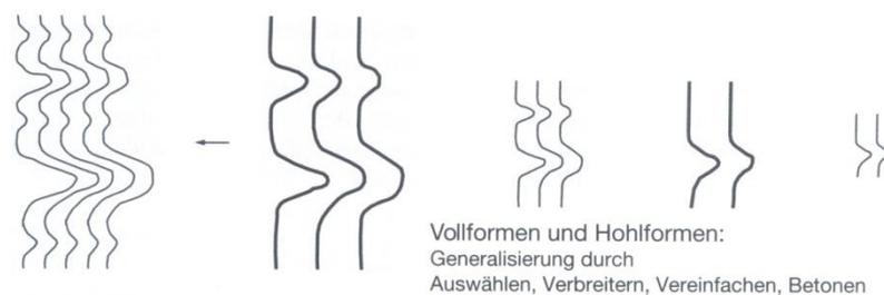
**Abbildung 2.6** Schematische Beispiele der Reliefgeneralisierung. Höhenlinien im Ausgangsmaßstab und Folgemaßstab (Hake et al., 2002, S. 430)
