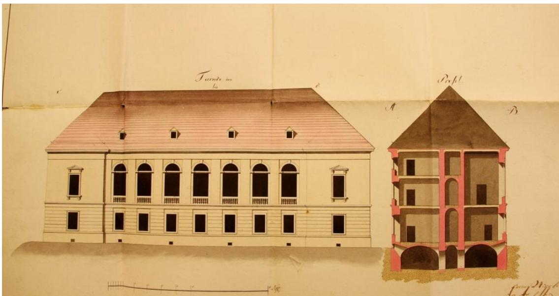
Abb. 20: Franz Wipplinger, Einreichplan / Gartenpalais Modena: Fassadenaufriß und Querschnitt des rechten Seitenflügels, 1803, WStLA, Wien.
