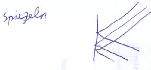
Abbildung 48: Skizze zum Verlauf des Lichtes, welches auf eine Spiegeloberfläche auftrifft
