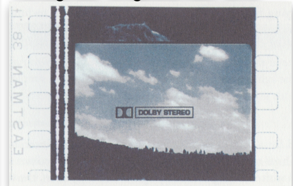
Abb. 21: Filmstreifen. Links vom Bild ist deutlich die gewellte Stereo-Lichtspur sichtbar
