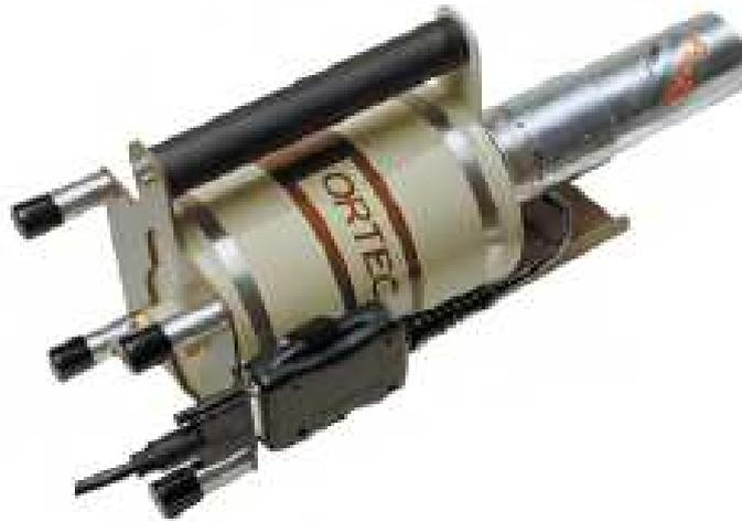
*Abb. A 2.6: Der verwendete Germaniumdetektor samt Vorverstärker der Fa. Ortec. Ein Datenblatt des Detektors befindet sich in Anhang C-3*
