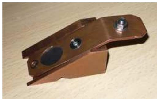
*Abb. 2.4: Das linke Bild zeigt den, auf einem Montageflansch montierten Faraday-Cup-Targethalter. So wird er von oben in das Doppel-T-Stück eingesetzt. Das obere Bild zeigt den Targethalter auf dem keilförmigen Einschubstück montiert.*
