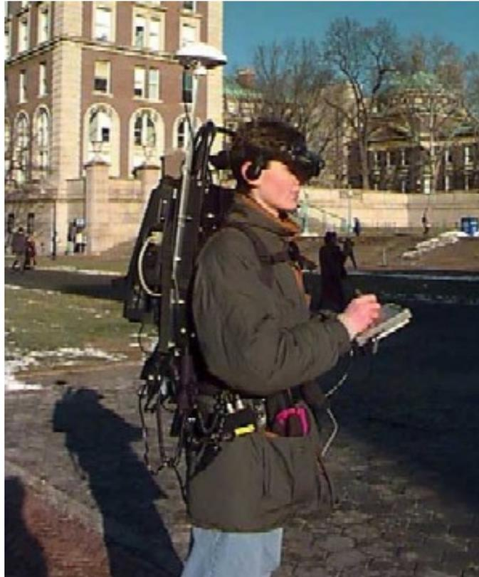
Abbildung 7.1.: „Touring Machine“ der University of Columbia [FMHW97]
