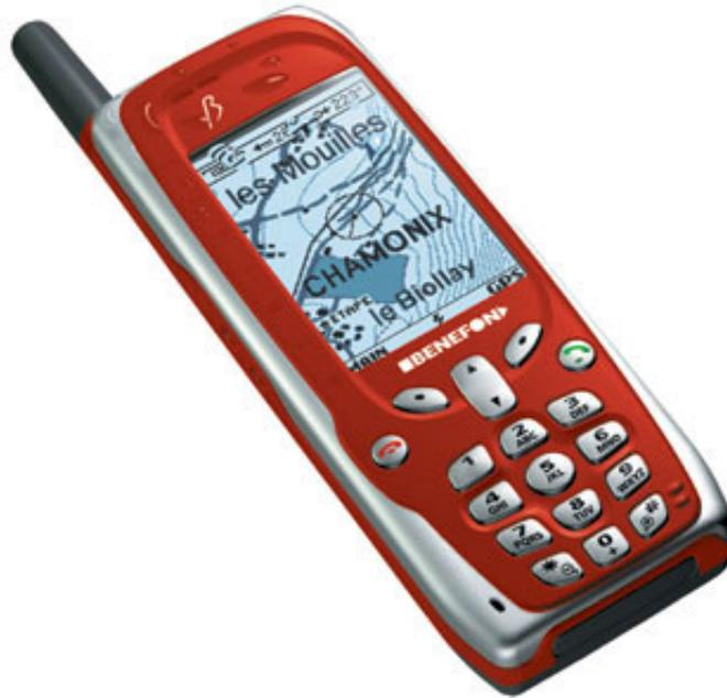
Abbildung 7.9.: Das erste GPS-fähige Mobiltelefon der finnischen Firma Benefon [Benb]
