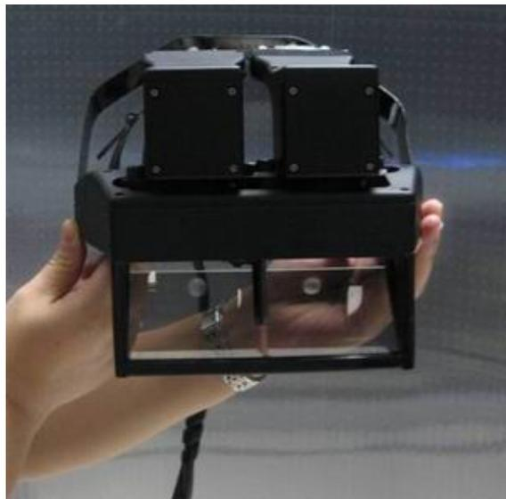
Abbildung 3.5.: Beispiel eines polarisierten *Head-Mounted Projectors Displays* [PHM]
