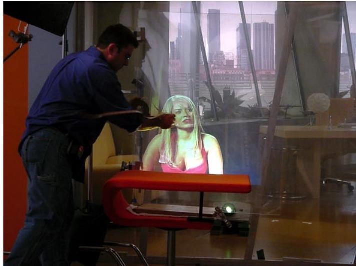
Abbildung 3.8.: Beispiel eines *Spatial Optical See-Through Displays* anhand einer transparenten Leinwandprojektion [Mea]
