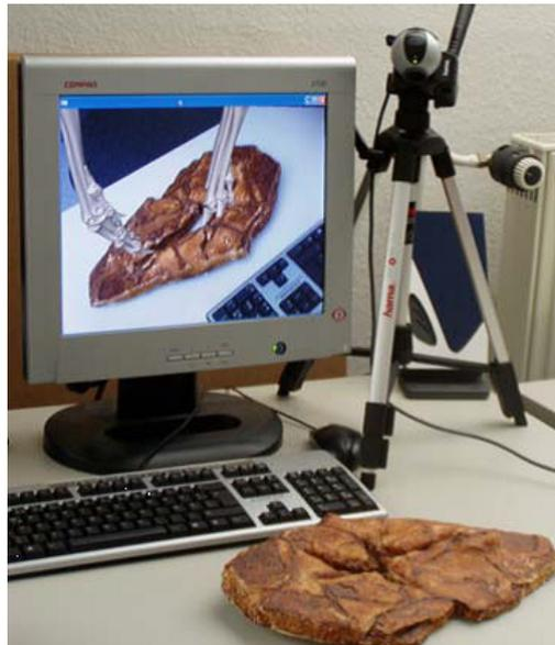
Abbildung 3.7.: Beispiel eines *Screen-Based Video See-Through Displays* [BR05]
