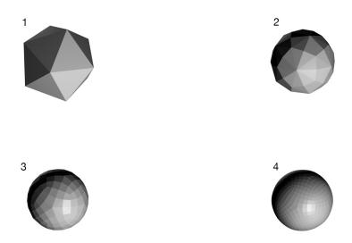
Abb. 1: Ein platonischer Körper - in diesem Fall ein Ikosaeder - kann in nur vier Stufen mittels Subdivision Surfacing in eine Kugel verwandelt werden. (Quelle: Eigene Darstellung)
