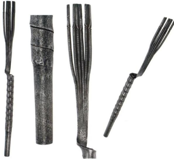
Die verschiedenen Arbeitsgänge bei der Herstellung eines Damastlaufes aus
