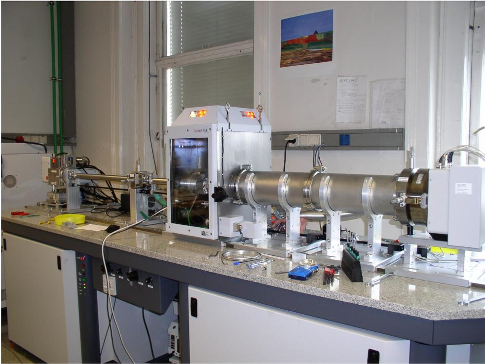
Abbildung 3.0.1: Die SAXS-Anlage in der langen Konfiguration. Für die Reflektivitätsmessungen wurden die Rohre zwischen der Probenkammer (mittig im Bild) und dem Detektor (rechts im Bild) entfernt.
