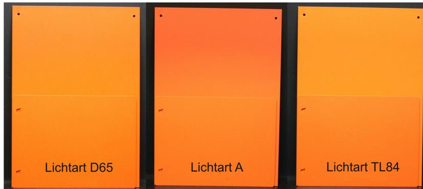
Abbildung 1.2: Metame Farbwirkung von zwei Farbfeldern pro Tafel mit unterschiedlichen Reflexionsfunktionen bei verschiedenen Lichtquellen: mittleres Tageslicht D65 mit einer Farbtemperatur von 6504 K, Glühbirne A mit ca. 3000 K und Dreibandleuchtstoffröhre TL84 (F11) mit 4000 K.
