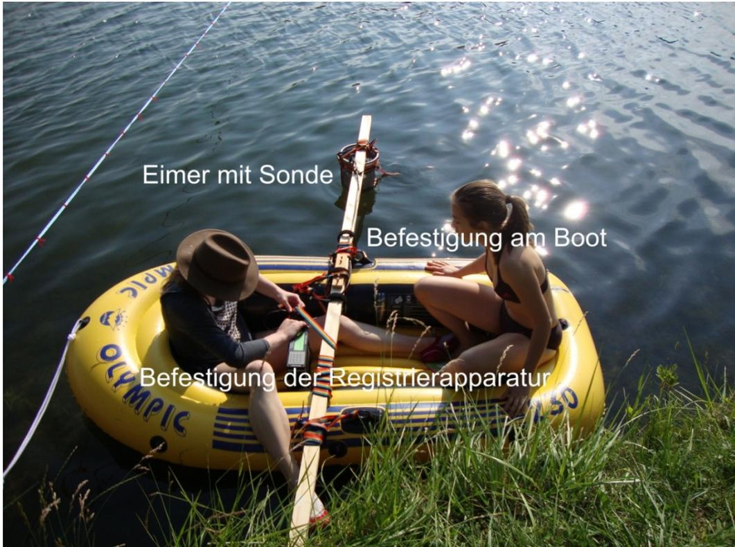
Abb. 3-9 Holzkonstruktion in Verwendung mit einem Schlauchboot
