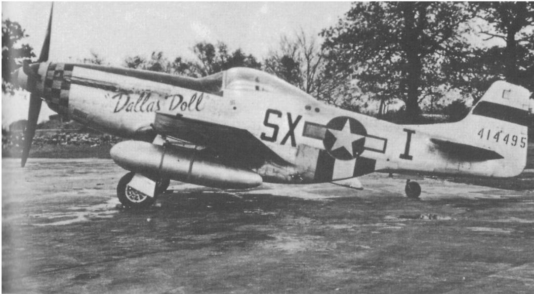
**Eine North American P-51 „Mustang“, ausgerüstet mit abwerfbaren Treibstoffbehältern, durch die sich die Reichweite des Jagdflugzeuges signifikant erhöhte.**
