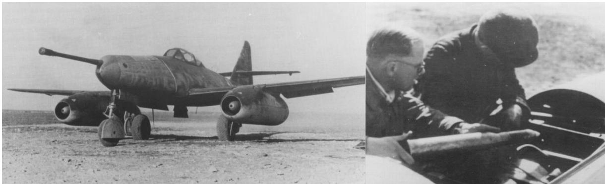
**Me 262 A-1a/U-4 „Pulkerstörer“. Rechts: Messerschmitt-Testpilot Karl Bauer beim Laden der MK214-Kanone (Kaliber 50 Millimeter). Lechfeld, März 1945.**
