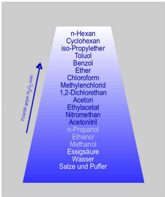
Abb. 1: Eluotrope Reihe mit relativer Polarität zur Verwendung bei der RP-HPLC
