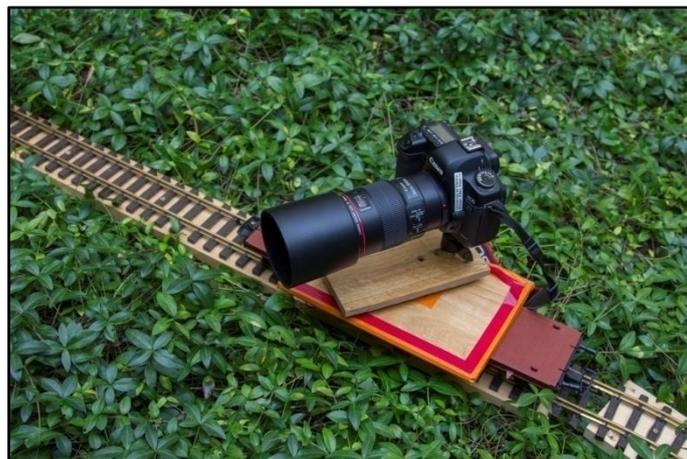
Abbildung 6: Kammerschiene mit Schwenkkopf
