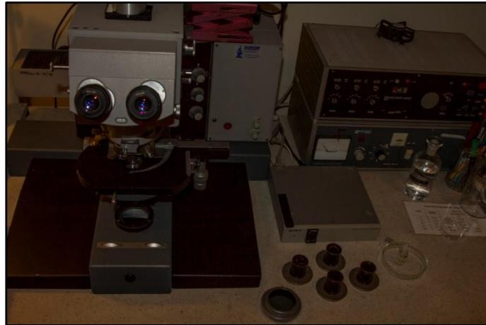
Abbildung 9: Reichert Univar Lichtmikroskop
