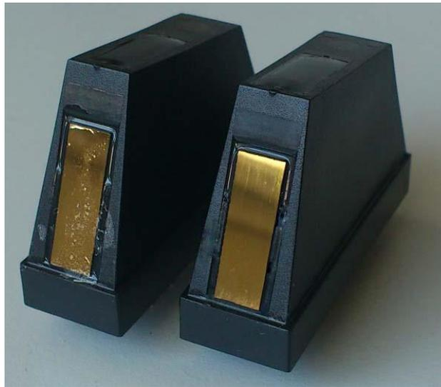
**Abbildung 64:** SPR Sensor ohne und mit MIP Beschichtung (links)
