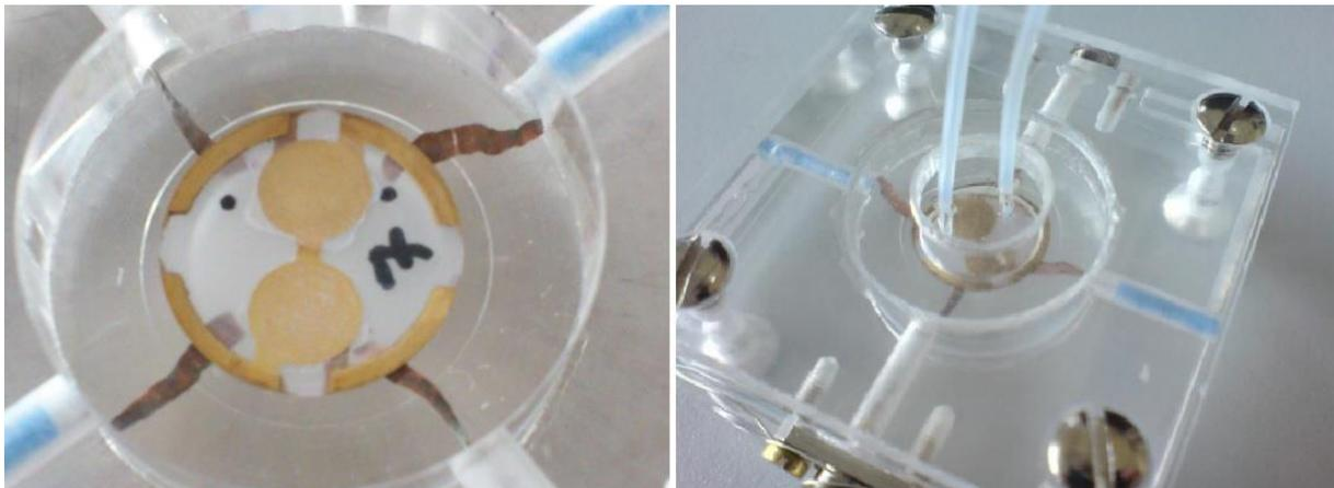
**Abbildung 40:** QCM mit zwei beschichteten Elektroden im Detail (links) und mit geschlossenem Deckel(rechts) in der Flüssigmesszelle
