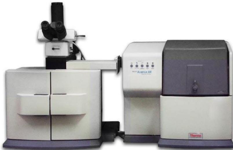
**Abbildung 45:** Thermo Nicolet Almega XR mit geschlossenem Probenraum und aufgesetztem Mikroskop (links) sowie Spektroskop und Laser (rechts). Bei einer Messung wird das Laserlicht direkt über die Optik des Mikroskops auf die zuvor fokussierte Stelle gelenkt. Währenddessen wird zur Sicherheit eine Blende hinter dem Okular geschlossen um Augenschäden des Benutzers zu verhindern.<sup>90</sup>
