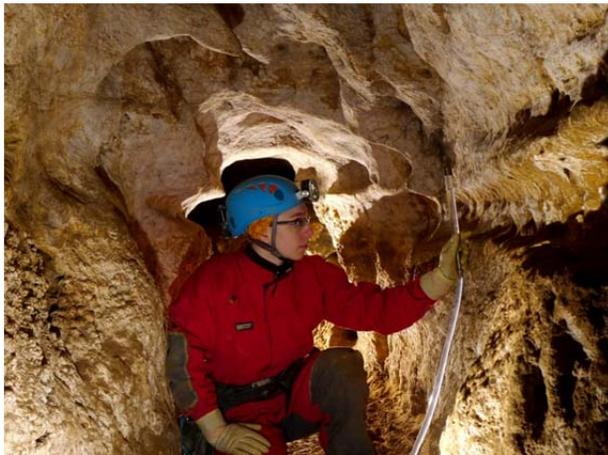
Abb. 2 Vermessung der Hohlkehlen mittels Schlauchwaage (*Rutsche*). Foto: L. Plan
