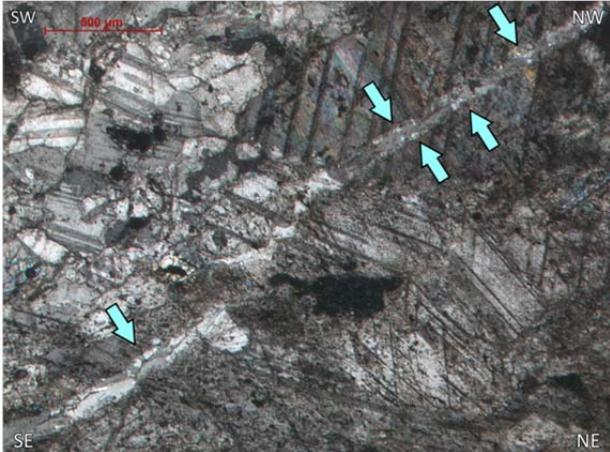
Appendix Abb. 6 Bulging oder Low-Temperature Grain Boundary Migration (Dünnschliff mit gekreuzten Polarisatoren).
