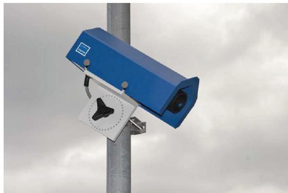
**Abbildung 2.11:** Lasermessgerät SHM - 30 zur Messung der Schneehöhe (Firma Jenoptik)
