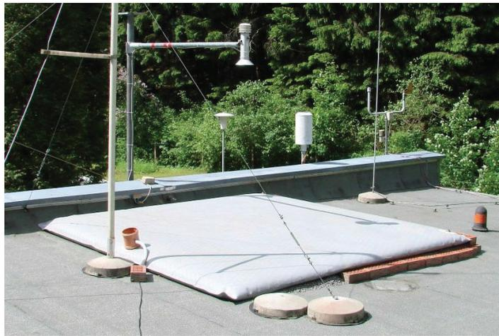
**Abbildung 2.9:** Schneekissen mit darüber installiertem Ultraschallmessgerät [12]
