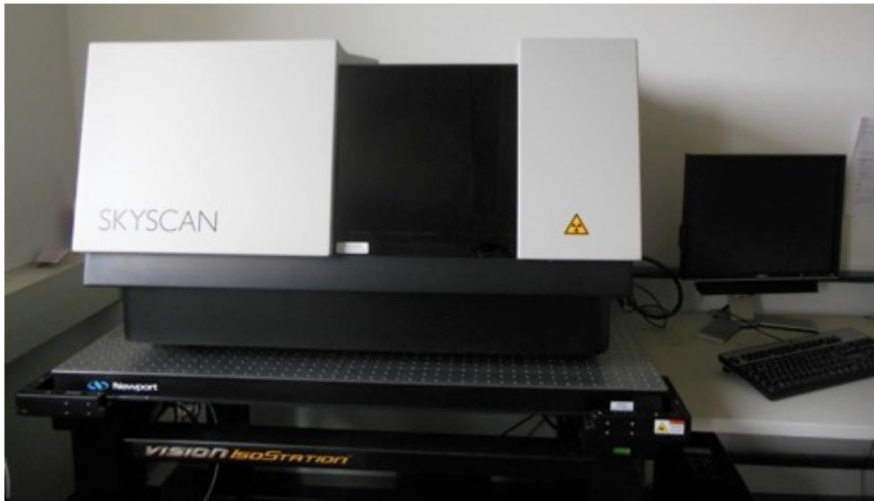
Abb. 25: Mikro-CT 1173 Skyscan mit Steuercomputer im Institut für Paläontologie, Wien.
