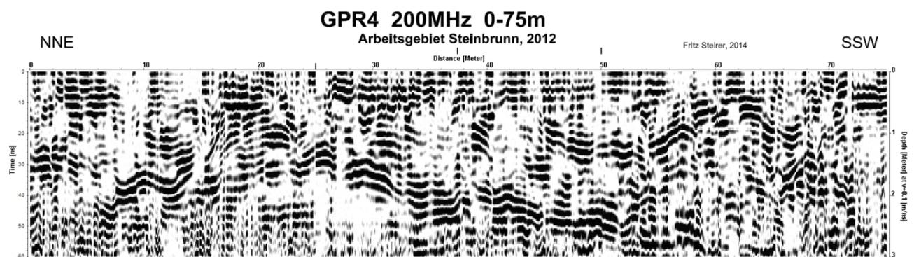
Abb. 106: Ergebnisdarstellung Profil GPR4, 0-75m
