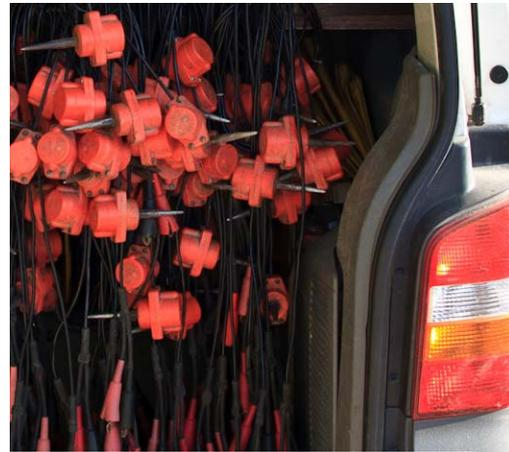
**Abb. 45: Geophone, die im Zuge des Geländepraktikums im September 2011 zum Einsatz kamen; Foto: Martin Leitner**
