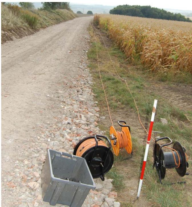
Die nächste Messsequenz wird mit einem Elektrodenabstand von 2a durchgeführt; zuerst werden die Elektrode 1, 3, 5 und 7 verwendet, danach die Elektroden 2, 4, 6 und 8, bis letztendlich -noch immer mit einem Abstand von 2a- die Elektroden 14, 16, 18 und 20 verwendet werden (Loke, 2013).
