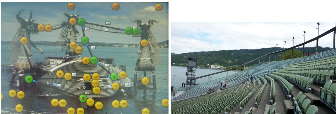
Abb. 3.18: Open-Air-Beschallung auf der Seebühne Bregenz Links: Richtungsmischer zur Positionierung von Schallquellen auf der Bühne. Rechts: Lautsprecherarray seitlich und hinter dem Publikum zur Raumsimulation durch Wellenfeldsynthese.
